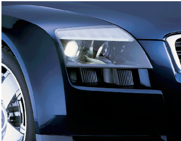
Audi Avantissimo (Studie, Hella): schwenkbares Kurvenlicht
