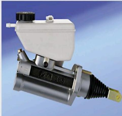
Im Vergleich zu den derzeit üblichen Bremsanlagen wird bei der Elektrohydraulischen Bremse EHB durch Betätigung des Bremspedals der entsprechende Befehl elektronisch an den Rechner der Hydraulikeinheit übertragen. Diese ermittelt den optimalen Bremsdruck und betätigt hydraulisch die Bremszylinder.
