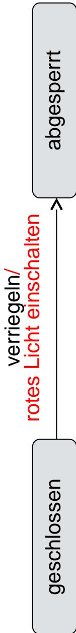
$\text{trans}(\text{geschlossen}, \text{verriegeln}) = (\text{abgesperrt}) / \text{rotes Licht einschalten}$
