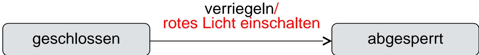
$\text{trans}(\text{geschlossen}, \text{verriegeln}) = (\text{abgesperrt}) / \text{rotes Licht einschalten}$
