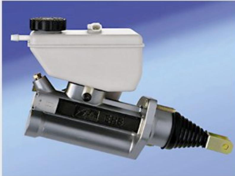
Im Vergleich zu den derzeit üblichen Bremsanlagen wird bei der Elektrohydraulischen Bremse EHB durch Betätigung des Bremspedals der entsprechende Befehl elektronisch an den Rechner der Hydraulikeinheit übertragen. Dieser ermittelt den optimalen Bremsdruck und betätigt hydraulisch die Bremszylinder.
