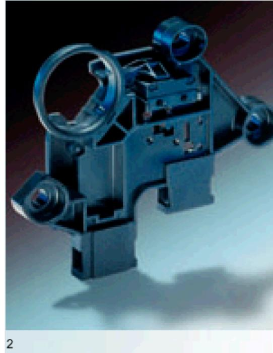
**Bild 2** Ansteuerungsmodul für die Zusatzheizung. Kompakte Einheit, bestehend aus umspritztem Stanzgitter mit angeformtem Stecker und als Schaltungsträger für den wasserdichten DCJK-Schalter und elektronische Bauelemente.
