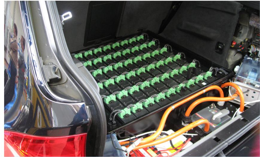
Einbau der Lithium-Ionen-Batterien im Heck
