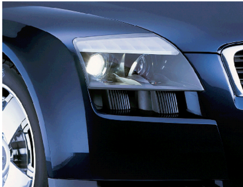
Audi Avantissimo (Studie, Hella): schwenkbares Kurvenlicht
