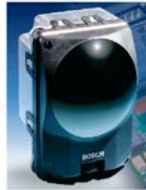
ACC-Radarsensor im One-Box-Design (Fiat Stilo)
