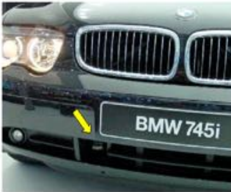
ACC-Sensoreinbau im Stoßfänger (BMW 7er, E65)
