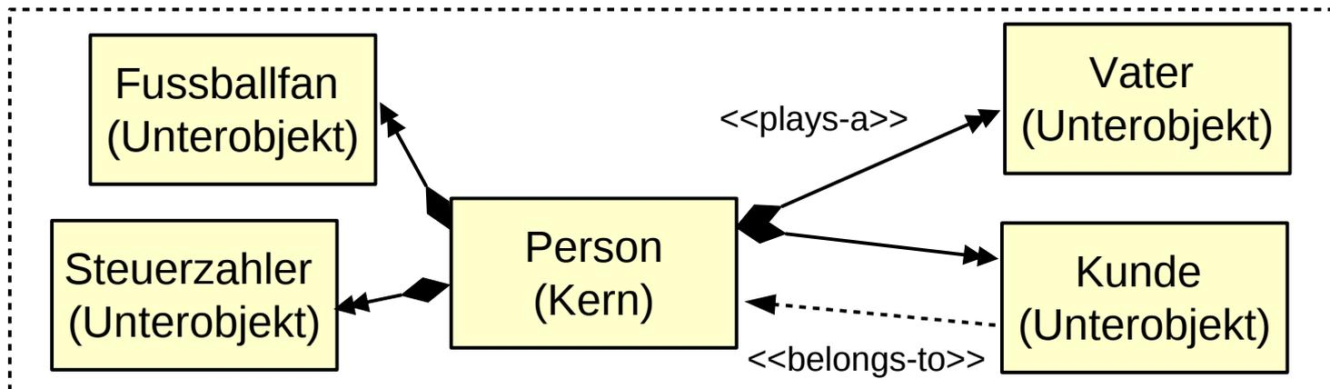
Schon in der Analyse werden komplexe Objekte aus einem *Kern* und einer Menge von zugehörigen *Unterbjekten* (Teilobjekte, Satelliten) dargestellt
