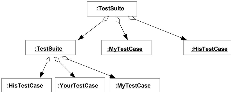
Ein **Snapshot (Objektdiagramm)** zeichnet eine Konfiguration eines Objektnetzes zur Laufzeit eines objektorientierten Programms auf.
