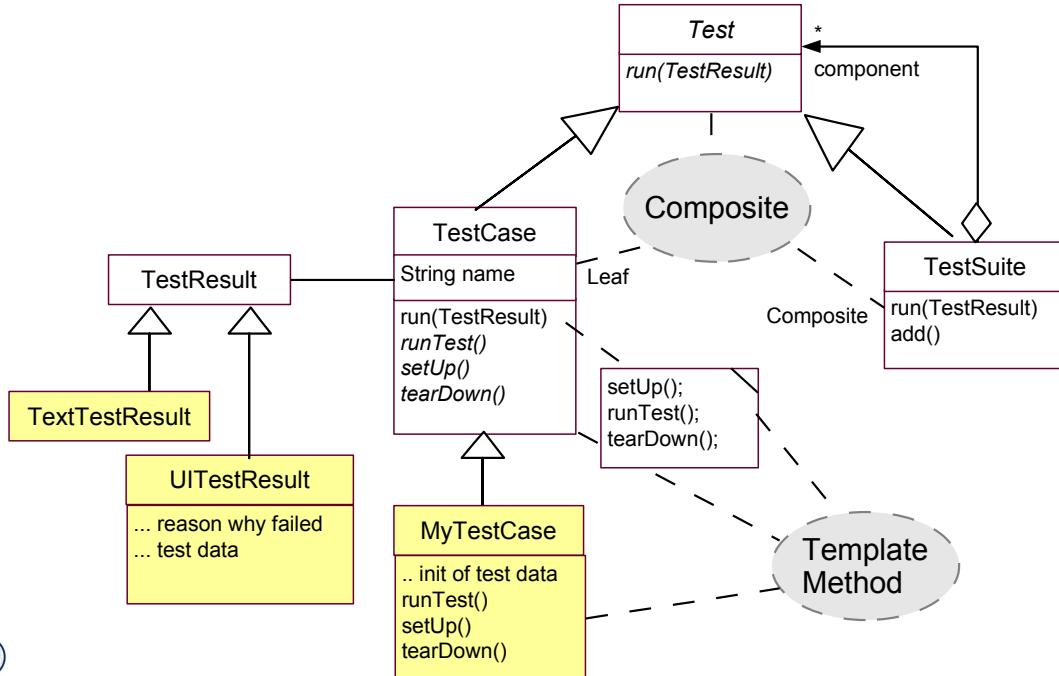
Man erweitert das Entwurfsmuster Composite aus dem jUnit-framework durch eigene Klassen (gelb). Dadurch ruft das Framework die Anwendungsklassen auf ("don't call us, we call you"). Der Steuerfluss liegt also im Framework.
