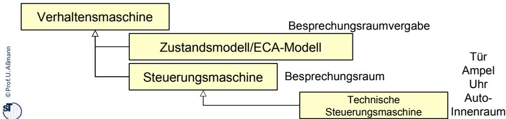
Fast alle technischen Geräte können mit Steuerungsmaschinen beschrieben werden. Daher sind Steuerungsmaschinen für die Modellierung von Software für eingebettete oder cyber-physische Systeme sehr wichtig.
