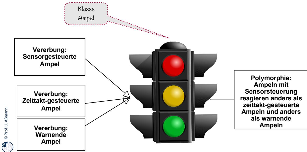
Ampeln können verschiedene Steuerungsalgorithmen haben (zeitgetaktet, sensorgesteuert, warnend- blinkend). Diese Algorithmen können über die Phasen des Tages, dem Lebenszyklus der Ampel, wechseln.
