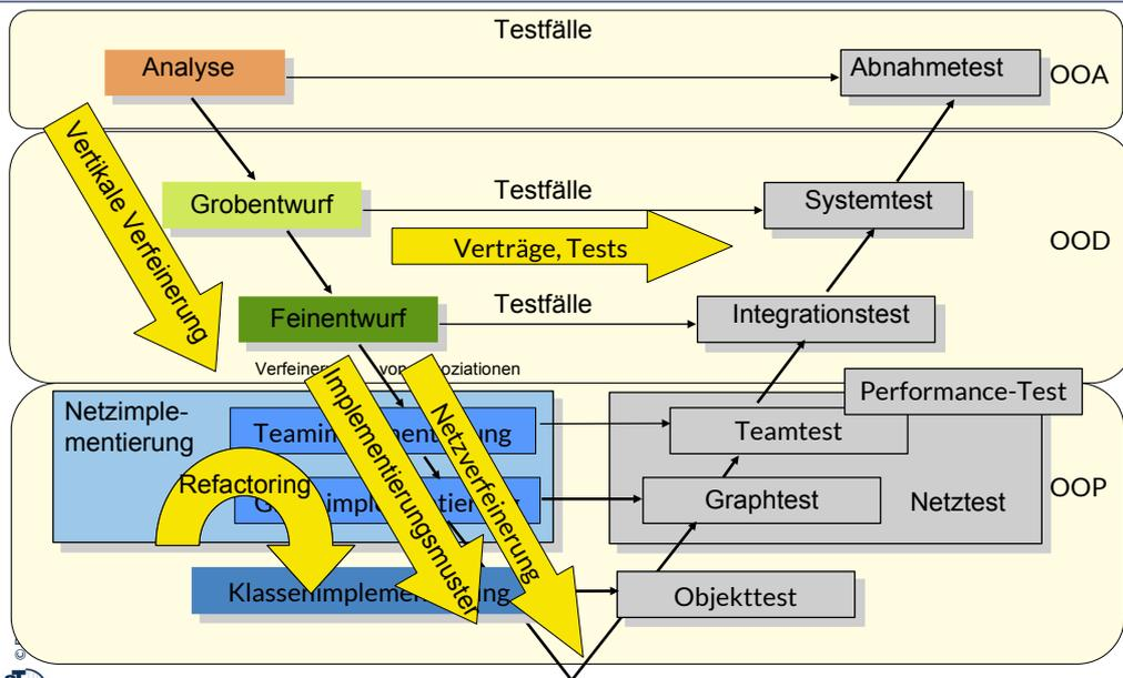
Die stufenweise Verfeinerung von dem Pflichtenheft, dem Ergebnis der Analyse aus, hin zur Implementierung beinhaltet Netzverfeinerung und Teamverfeinerung.
